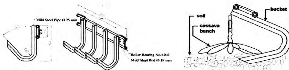
ภาพที่ 4.18 ลักษณะลูกกระท้อที่ออกแบบ (ซ้าย) จังหวะการตัดเหง้าฯ (ขวา)
