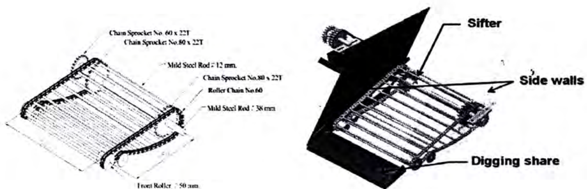
ภาพที่ 4.16 ภาพร่างแนวคิดตะแกรงแยกดิน (ซ้าย) และชุดอุปกรณ์ชุดและเตรียมเหง้ามันสำปะหลัง (ขวา)
