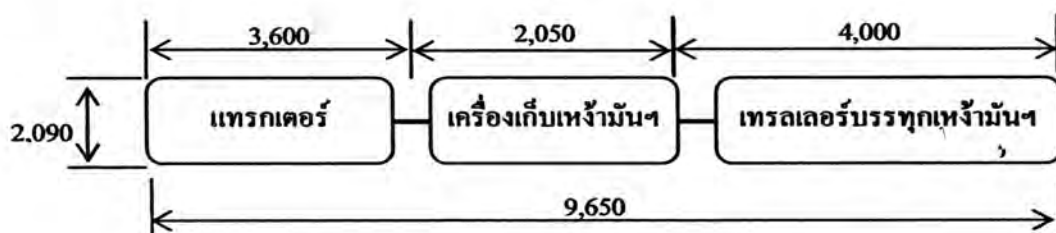
ภาพที่ 4.10 มิติของขบวนเก็บเหง้ามันสำปะหลัง กรณีแทรกเตอร์พ่วงเครื่องเก็บและเทรลเลอร์บรรทุกเหง้ามันฯ
