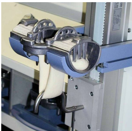
ภาพที่ 2.8 แท่นจับ (balance arm) พร้อมด้วยตัวยึดชิ้นโด (holder) และตัวเกี่ยวรูปตะขอของเครื่อง Extensograph
