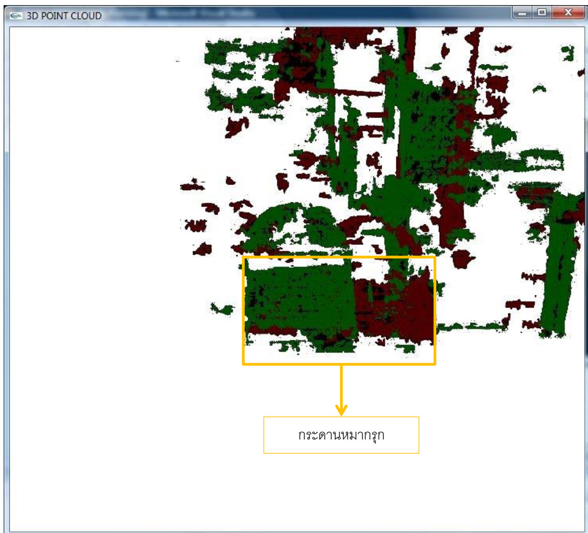
รูปที่ 3.1 (ข) ภาพสามมิติจากแกนสามมิติแกนที่ 1 และแกนที่ 2 จากคู่ภาพลำดับที่ 3 รูปที่ 3.1 ภาพสามมิติ (ก) และ (ข) จากแกนสามมิติแกนที่ 1 (รูปสีแดง) และแกนที่ 2 (รูปสีเขียว) โดยที่แกนสามมิติทั้งสองแกนนั้นอยู่คนละตำแหน่งกัน
