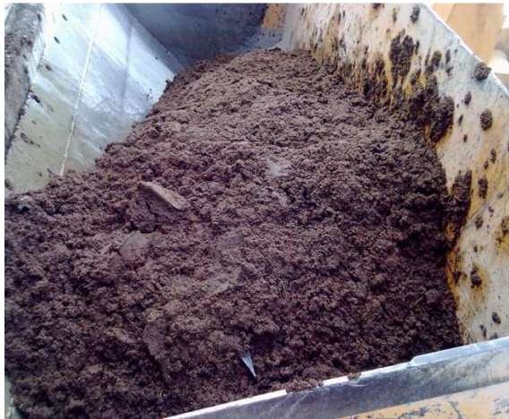
ภาพที่ 4.5 ทรายที่ตกค้างในถังหมักเอทานอลจากมันเส้นที่นำเข้าจากประเทศไทย ที่มา: บริษัท Guangxi COFCO Bio-energy Co., Ltd
