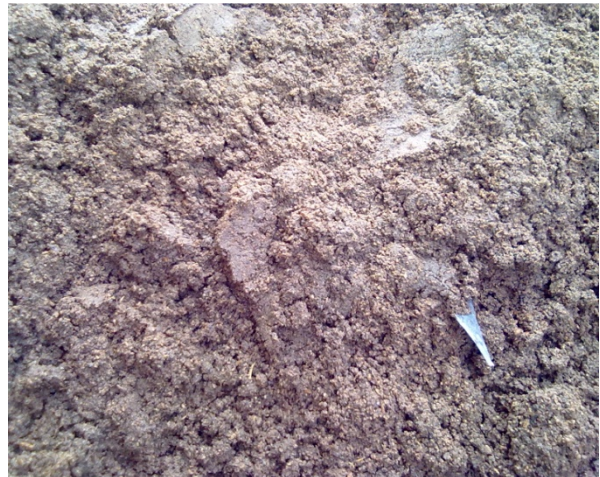
ภาพที่ 4.5 ทรายที่ตกค้างในถังหมักเอทานอลจากมันเส้นที่นำเข้าจากประเทศไทย ที่มา: บริษัท Guangxi COFCO Bio-energy Co., Ltd
