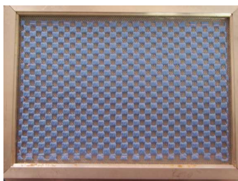
ภาพผนวกที่ ๕ ตะแกรงที่ใช้ในการขึ้นรูปวัสดุกันกระแทกจากเศษกระดาษลูกฟูก
