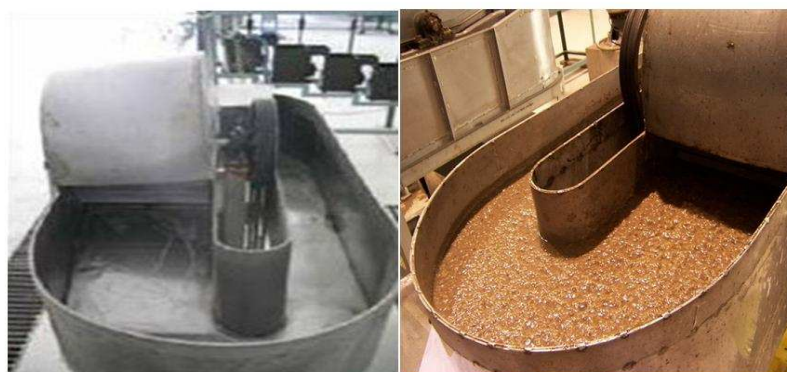
ภาพผนวกที่ ง2 เครื่องตีเยื่อแบบฮอแลนด์เดอร์ กำลังการผลิต 5 กิโลกรัม
