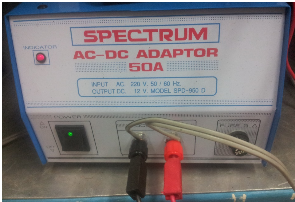
รูปที่ ข-9 หม้อแปลงกระแสไฟฟ้า AC เป็น DC
