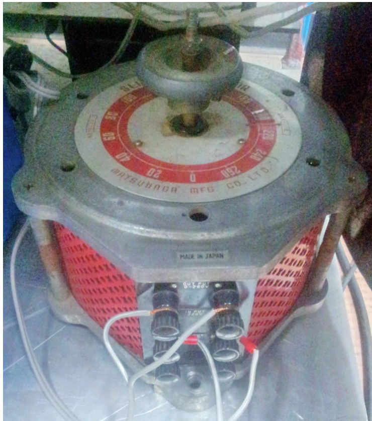
รูปที่ ข-11 หม้อแปลงแรงดันไฟฟ้าแบบปรับค่าได้ (Variac)
