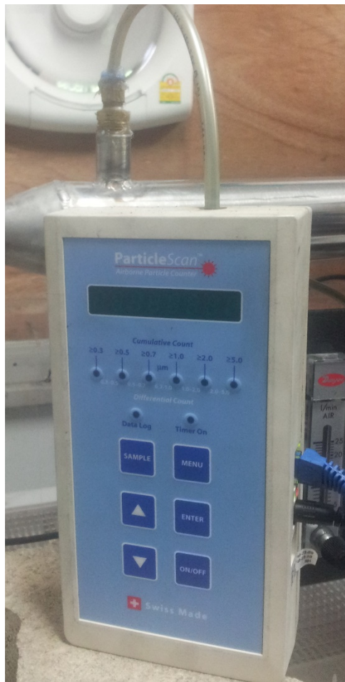
รูปที่ ข-5 เครื่องวัดจำนวนอนุภาคระดับเล็กกว่า 1 ไมครอน
