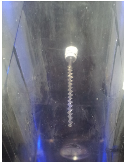
(ก) วางทิศทางการเคลื่อนที่ของอากาศ (ข) วางแนวทางการเคลื่อนที่ของอากาศ รูปที่ 4.12 ลักษณะการวางแนวพื้นเลื่อยของดีสชาร์จี้เล็กโทรด ในการทดสอบจริง
