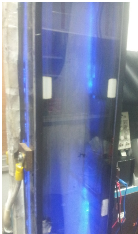
รูปที่ 4.25 การเกิดไอน้ำไปเกาะที่ผิวผนังอุโมงค์ลม
