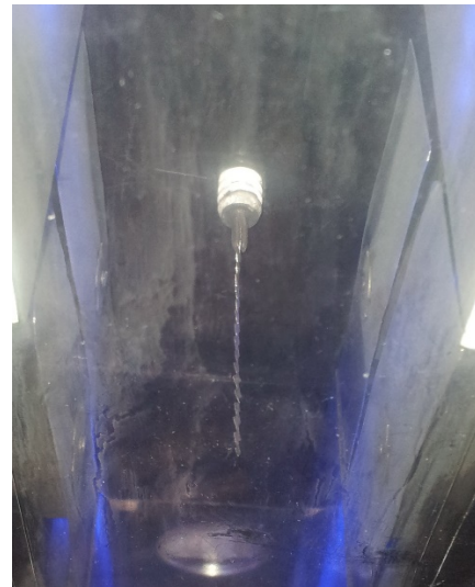
(ก) วางทิศทางการเคลื่อนที่ของอากาศ (ข) วางแนวทางการเคลื่อนที่ของอากาศ รูปที่ 4.12 ลักษณะการวางแนวพื้นเลื่อยของดีสชาร์จี้เล็กโทรด ในการทดสอบจริง
