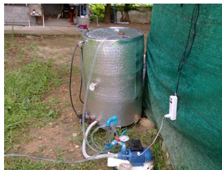
รูปที่ 4 ถังควบคุมอุณหภูมิสารละลายธาตุอาหารสำหรับทดสอบประสิทธิภาพของชุดระบายความร้อน
