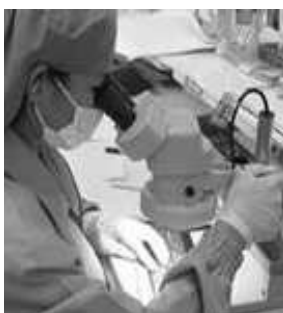
ภาพที่ 4.2 แสดงภาพตัวอย่างการตรวจสอบเศษทองแดงที่ตกค้างบนผลิตภัณฑ์ โดยกล้องจุลทรรศน์
