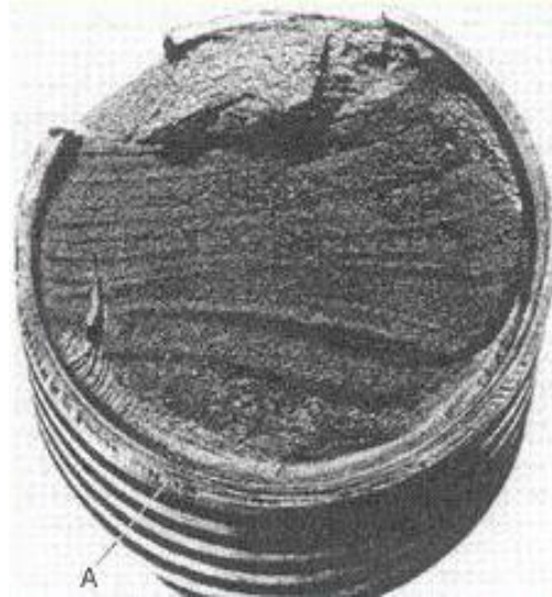
รูปที่ 2.12 ตัวอย่างผิวหน้าความเสียหายจากการล้าของสกรูสตีเหล็ก [12]
