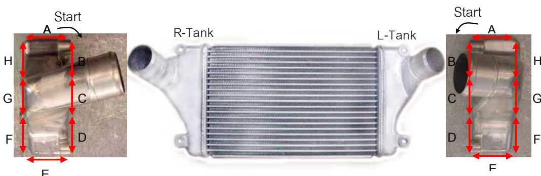
ภาพที่ 4.3 แสดงทิศทางการเริ่มต้น-สิ้นสุดการเชื่อม และการกำหนดตำแหน่งที่เกิดของเสียของแท่งค์ทั้งสองด้าน
