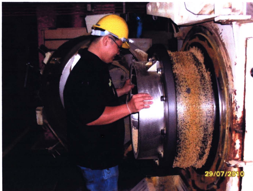
รูป 4.26 พนักงานยก Feed Cone เพื่อถอดเปลี่ยนลูกกลิ้งและตะแกรง
