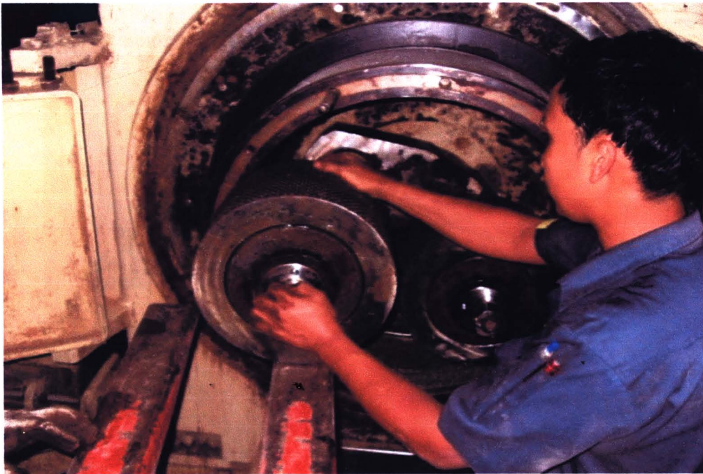
รูป 3.2 พนักงานกำลังเปลี่ยนลูกกลิ้งเครื่องอัดเม็ด
