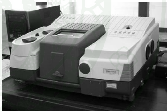
ง.เครื่องฟูเรียร์ทรานฟอร์ม สเปคโตรมิเตอร์
