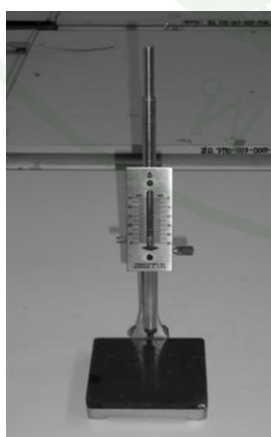
ก.อุปกรณ์ทดสอบการก่อตัวแบบไวแคต
