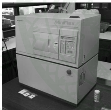
ค.เครื่องเอกซเรย์ดิฟแฟรคโตมิเตอร์
