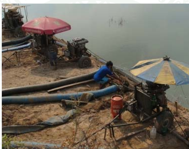
ภาพที่ 56 การผันน้ำจากแม่น้ำมูลสู่กุดขาคิมโดยใช้เครื่องรถยนต์เก่าปรับแต่งใช้แก๊สเป็นเชื้อเพลิง
