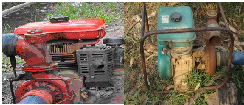
ภาพที่ 49 เครื่องสูบน้ำสำหรับสูบน้ำเข้าแปลงนา
