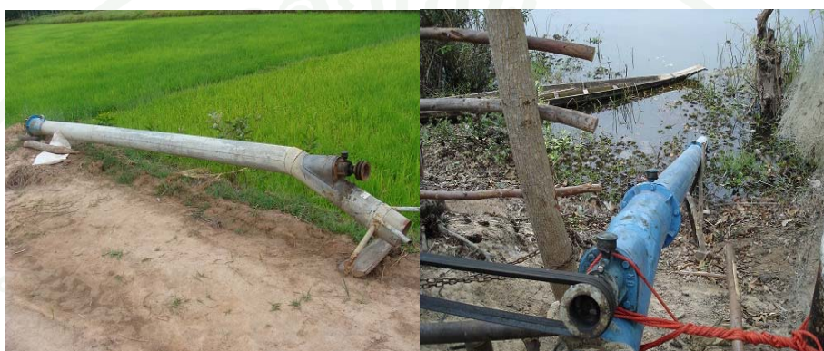
ภาพที่ 52 ท่อพญานาคสำหรับสูบน้ำขึ้นจากแหล่งน้ำสู่พื้นที่นา
