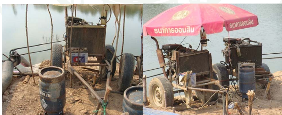
ภาพที่ 51 เครื่องรถยนต์เก่าปรับแต่งใช้แก๊สเป็นเชื้อเพลิงสำหรับสูบน้ำ
