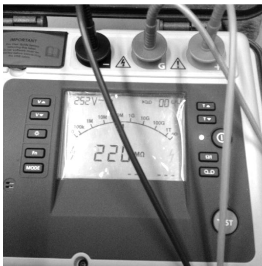
รูปที่ 3.14 การอ่านค่าความต้านทานไฟฟ้าเชิงพื้นผิวที่วัดได้จากเครื่องทดสอบ
