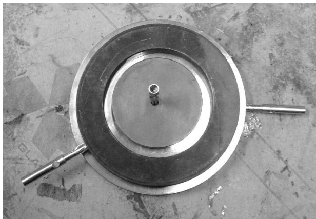
รูปที่ 3.12 ลักษณะของอิเล็กโทรดที่ใช้ในการทดสอบ
