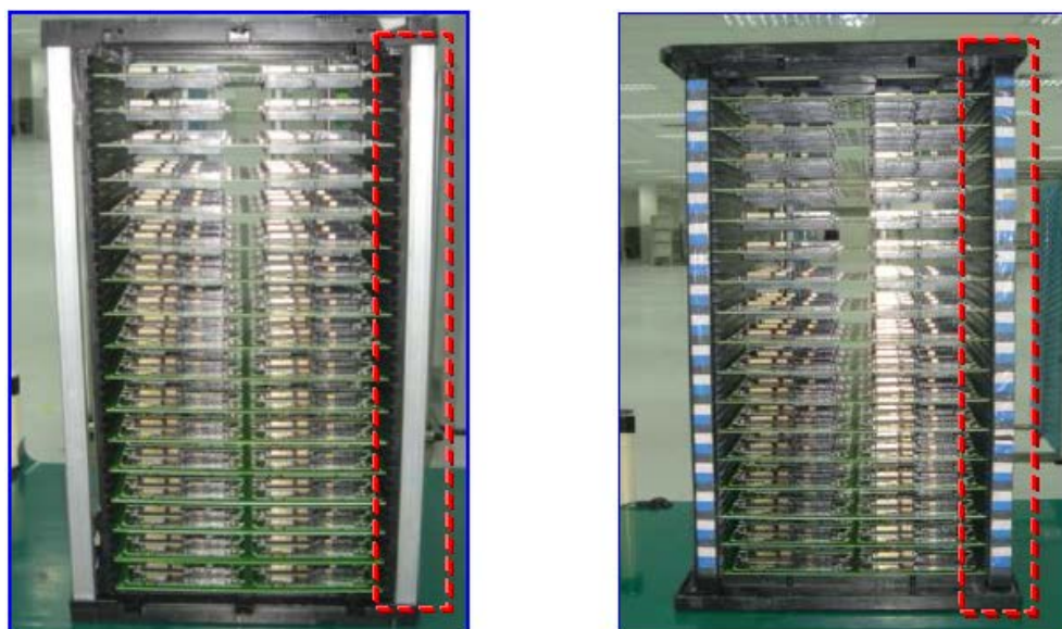
ภาพที่ 4.2 แนวทางการปรับปรุงแก้ไขกล่องใส่ PCBA ณ สถานีสแกน SFDC สถานีตรวจสอบ POI และสถานีตรวจสอบ AOI (ซ้าย: ก่อน, ขวา: หลัง)
