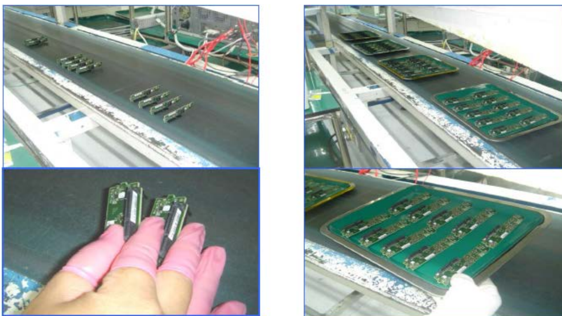
ภาพที่ 4.5 แนวทางการปรับปรุงแก้ไขปรับปรุงขั้นตอนการลำเลียง PCBA ณ สถานีเครื่องทดสอบการทำงานเบื้องต้น (ซ้าย: ก่อน, ขวา: หลัง)
