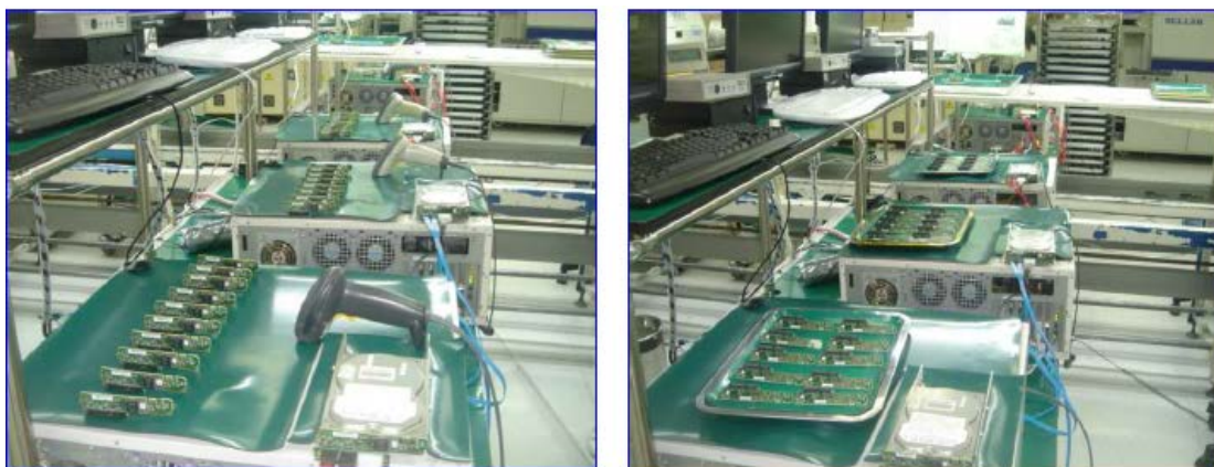
ภาพที่ 4.6 แนวทางการปรับปรุงแก้ไขปรับปรุงขั้นตอนการลำเลียง PCBA ณ สถานีเครื่องทดสอบการทำงานจริง (ซ้าย: ก่อน, ขวา: หลัง)
