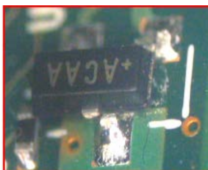
ภาพที่ 3.9 ภาพตัวอย่างลักษณะบกพร่องของอุปกรณ์ U5
