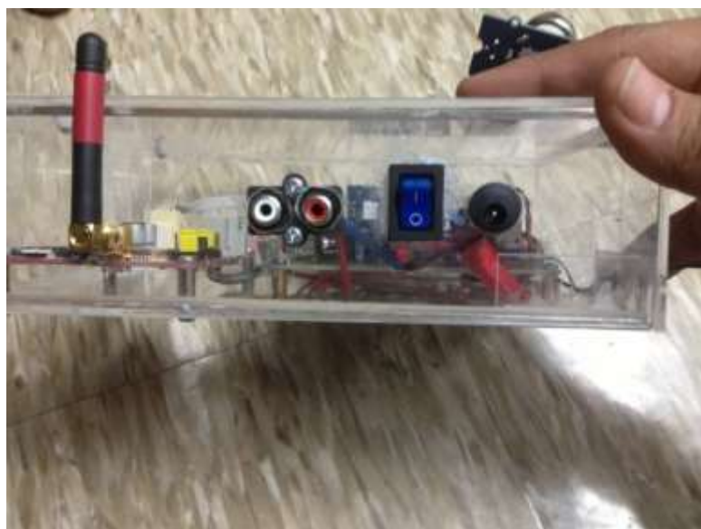
ภาพผนวก ข ที่ 11 สวิตช์ควบคุมการเปิด-ปิด ระบบแจ้งเตือนการรั่วไหลของก๊าซหุงต้มเพื่อการแจ้งเตือนฉุกเฉิน
