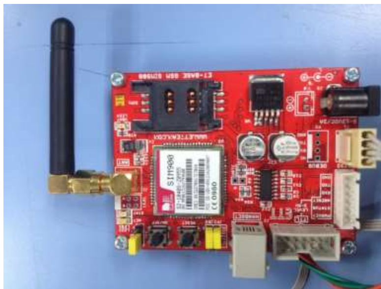
ภาพผนวก ข ที่ 3 แผงวงจรโมดูล GSM ควบคุมระบบการทำงานผ่านโทรศัพท์มือถือ
