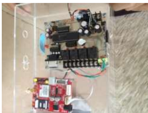
ภาพที่ 3.4 การออกแบบและสร้างกล่องสำหรับใส่แผงวงจรระบบตรวจจับการรั่วไหลของก๊าซหุงต้มเพื่อการแจ้งเตือนฉุกเฉิน
