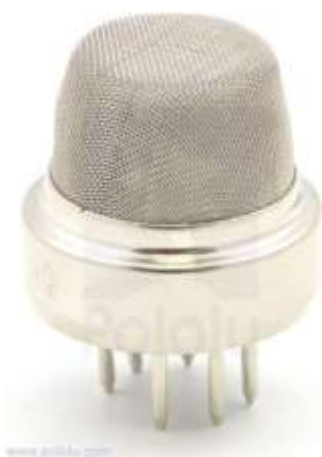
ภาพที่ 2.3 เซ็นเซอร์ตรวจจับก๊าซแอลพีจี ที่มา : (บริษัท วินัสซัพพลาย จำกัด, 2555)
