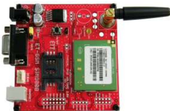
ภาพที่ 2.7 ภาพแสดงโมดูล GSM SIM900B ที่มา : (บริษัท อี.ที.ที จำกัด, ม.ป.ป.)
