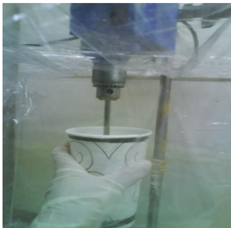
ภาพที่ 18 ขั้นตอนการผสมพอลิออลเรซินและไอโซไซยานต
