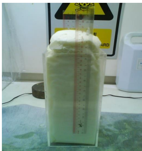
ภาพที่ 20 พอลิยูรีเทนโฟมหลังเสร็จสิ้นปฏิกิริยา
