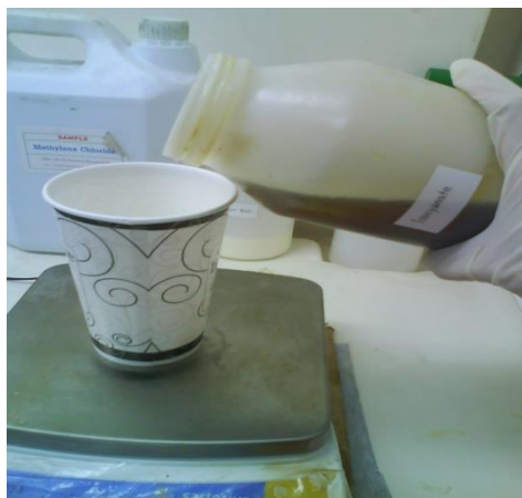
ภาพที่ 16 การเตรียมสารไอโซไซยานต
