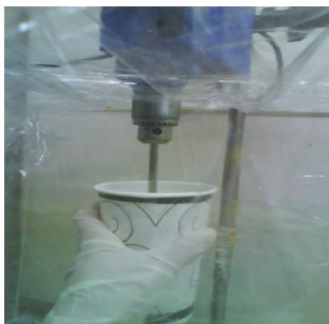
ภาพที่ 15 ขั้นตอนการผสมพอลิออลเรซิน
