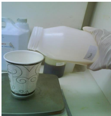
ภาพที่ 14 การเตรียมสาร Base polyol และ Co-polymer
