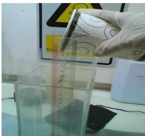
ภาพที่ 19 ขั้นตอนการเทสารผสมลง Mold
