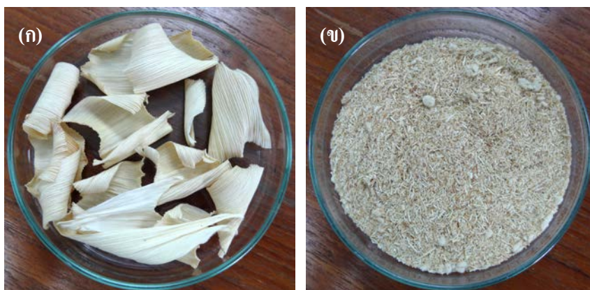
ภาพที่ 4.2 ลักษณะของเปลือกข้าวโพดฝักอ่อน : (ก) ภายหลังการอบที่อุณหภูมิ 55 °ซ เป็นเวลา 24 ชั่วโมง; (ข) ภายหลังจากบดให้มีขนาด 0.5 mesh เพื่อใช้ในการศึกษา
