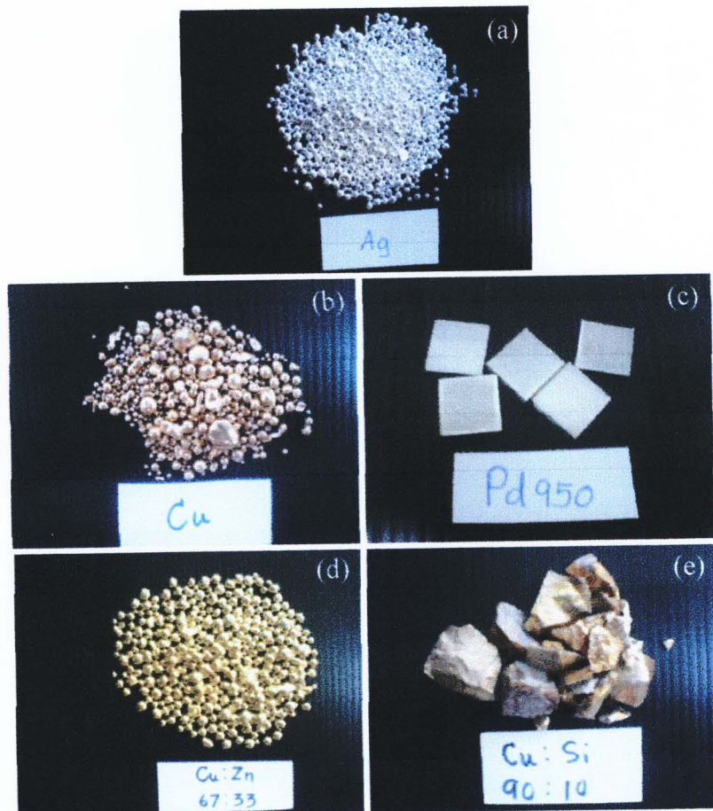
รูปที่ 3.1 โลหะที่ใช้ในการทดลอง (a) Silver (b) Copper (c) Pd950 (d) Master alloy Cu/Zn และ (e) Master alloy Cu/Si
