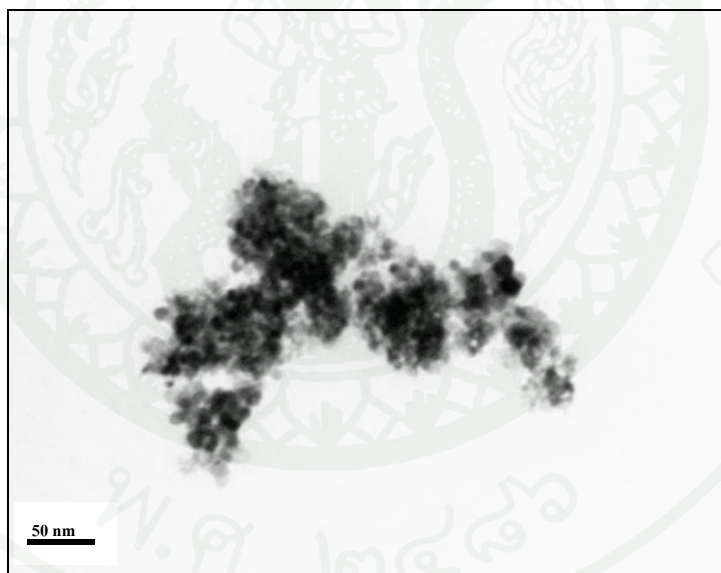
ภาพที่ 15 ภาพถ่าย TEM ของตัวเร่งปฏิกิริยา Ni/CeO 2 ที่เตรียมโดยวิธีการทำให้เอิบชุ่ม ที่ กำลังขยาย 300,000 เท่า
