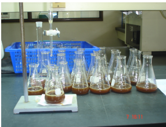
ภาพผนวกที่ ข4 (d) ไตเตรต ด้วย standardized 0.1 N AgNO 3 จนถึงจุดยุติ
