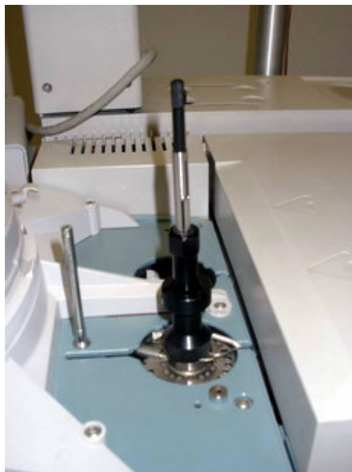
ภาพผนวกที่ 34 นำ SPME fiber ส่งตัวอย่างเข้าเครื่อง GC/MS
