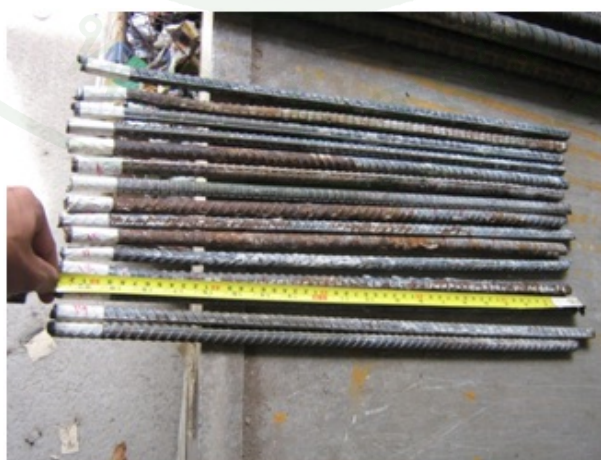
ภาพที่ 32 เหล็กเสริมที่ได้จากการเก็บตัวอย่างโครงสร้างสะพาน
