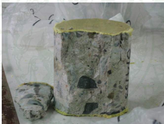
ภาพที่ 70 ลักษณะการวิบัติของตัวอย่างแบบ Shear and Splitting Failure
