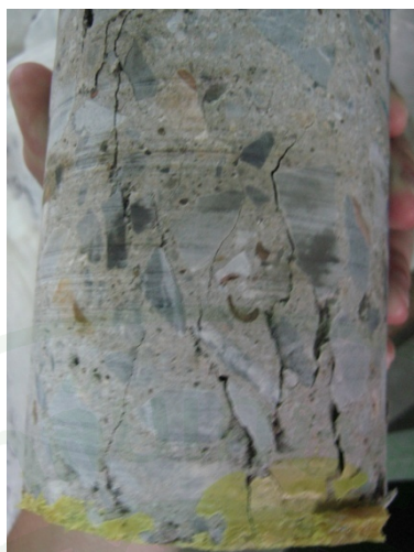
ภาพที่ 69 ลักษณะการวิบัติของตัวอย่างแบบ Splitting Failure
