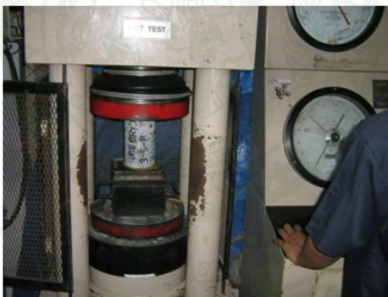
ภาพที่ 25 การทดสอบหาค่าลึงอัด (Compressive Strength) ในห้องปฏิบัติการ
