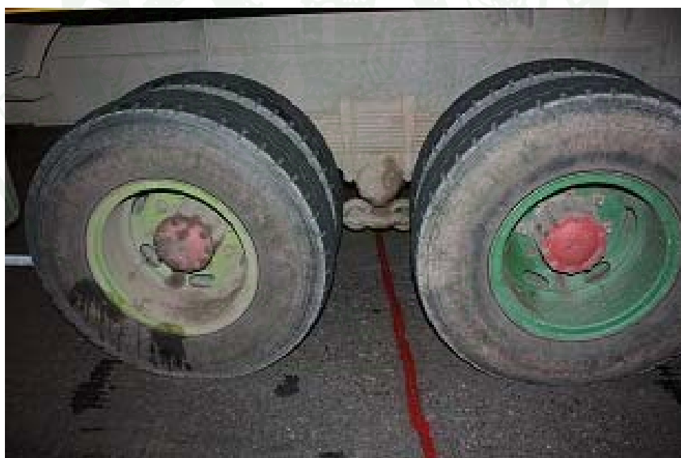
ภาพที่ 60 การหยุดรถบรรทุกทดสอบโดยตามตำแหน่งที่กำหนดพื้นสะพาน
