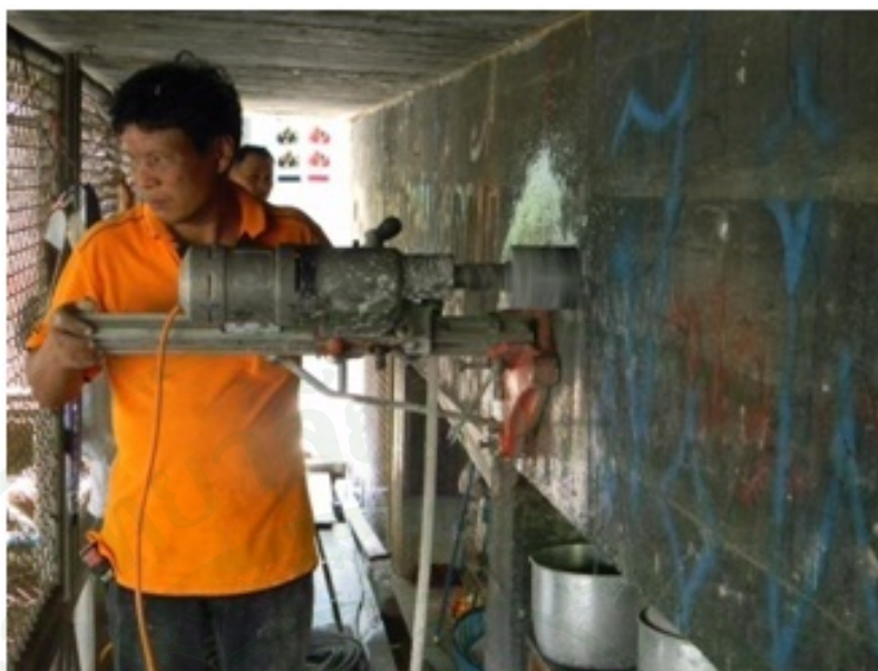
ภาพที่ 24 การเจาะเก็บตัวอย่างคอนกรีตตำแหน่งกานขวาง
