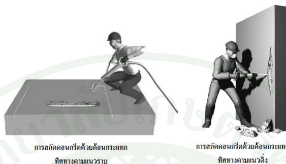
ภาพผนวกที่ ค2 การสกัดพื้นผิวคอนกรีตโดยใช้ค้อนกระแทกทิศทางแนวราบและแนวตั้ง
