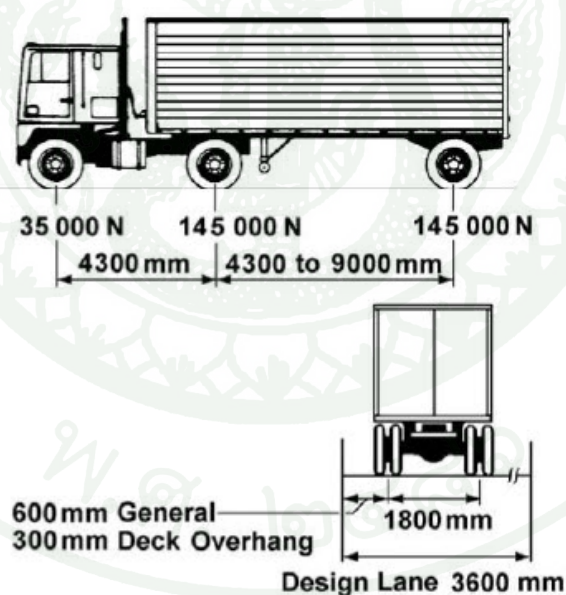
ภาพที่ 1 แบบจำลองน้ำหนักบรรทุก HS20-44 (Design load)
