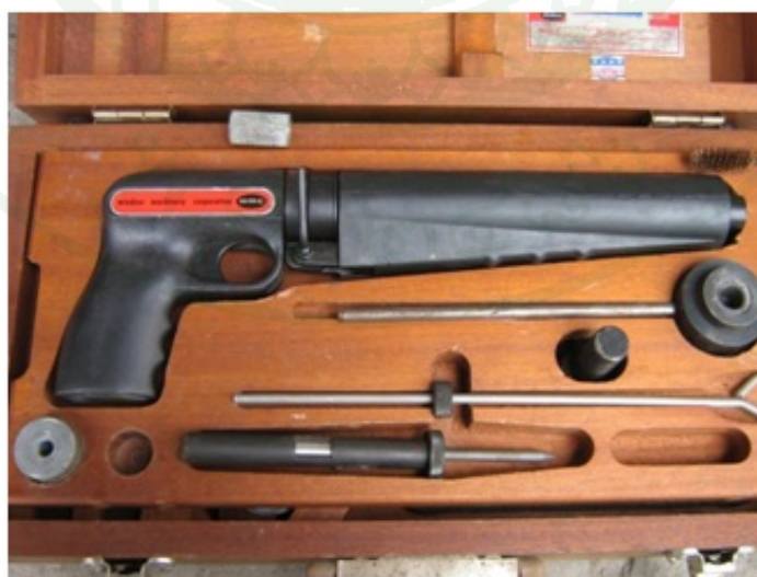
ภาพที่ 28 อุปกรณ์ทดสอบการวัดกำลังต้านทานการทะลวง (Windsor Probe)
