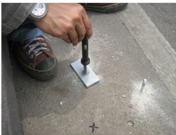
ภาพที่ 31 การวัดความยาวของเข็ม (Probe) ที่พ้นจากผิวหน้าของคอนกรีต
