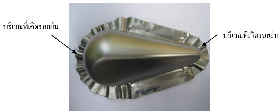
รูปที่ 4.10 ชิ้นงานใช้ดรอร์ปิดโลหะแรงกดชิ้นงาน 30 เปอร์เซ็นต์
