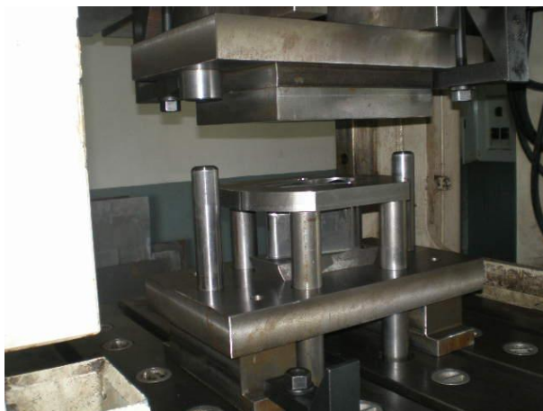
รูปที่ 3.16 การติดตั้งแม่พิมพ์บนเครื่องปั๊ม
