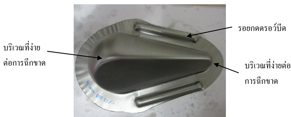
รูปที่ 4.11 ชิ้นงานใช้ดรอร์ปิดโลหะแรงกดชิ้นงาน 50 เปอร์เซ็นต์
