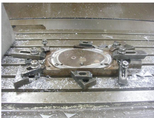
รูปที่ 3.5 การจับยึด (Fixture) บนเครื่องกัด CNC
