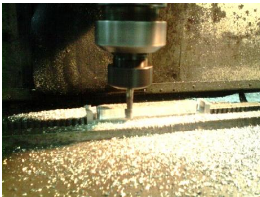
รูปที่ 3.8 การกัดขึ้นรูป (Profile) ครอว์บีด
