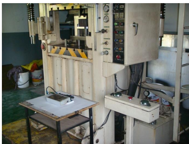
รูปที่ 3.26 การติดตั้งอุปกรณ์จัดเก็บสัญญาณต่อเข้ากับเครื่องเพรส
