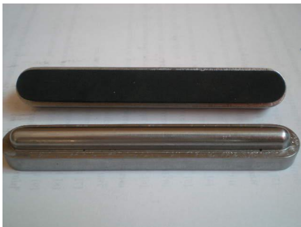
รูปที่ 3.23 ครอว์ปิดที่เสริมยางสังเคราะห์
