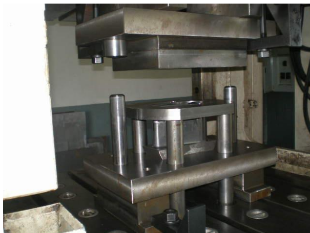
รูปที่ 4 การติดตั้งแม่พิมพ์บนเครื่องปั๊มไฮดรอลิกส์ 80 ตัน
