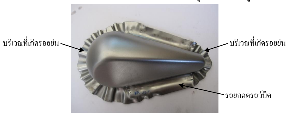
รูปที่ 4.13 ชิ้นงานใช้ครอว์บีคเสริมแรงยางธรรมชาติ แรงกดชิ้นงาน 30 เปอร์เซ็นต์
