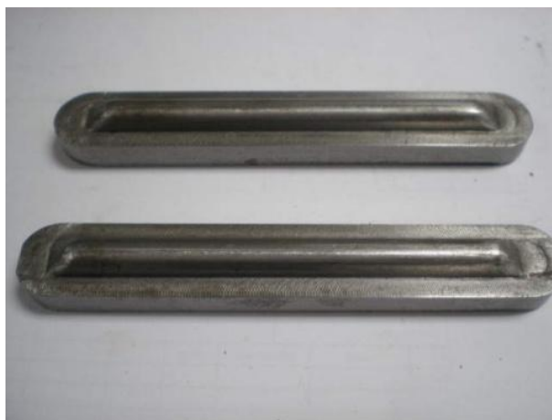
รูปที่ 3.21 ครอว์ปิดที่เป็นโลหะเหล็กชนิด S45C
