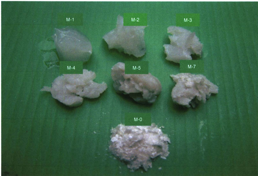
รูปที่ 4 สารผสมทางกายภาพของไขพืชจากกล้วยกับ Mineral oil ความเข้มข้นต่างๆ; M0 = ไม่มี Mineral oil, M1-M6 มี Mineral oil 5, 10, 20, 30, 50 และ 75% โดย น้ำหนักตามลำดับ
