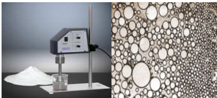
รูปที่ 2.22 การการผสมน้ำมันกับน้ำให้กลมกลืนโดยใช้เทคนิคอัลตราโซนิก
