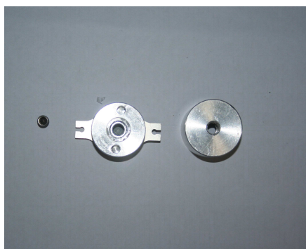
รูปที่ 2 อัลตราโซนิคทรานสดิวเซอร์, Coupling mass และอุปกรณ์ในการยึดติด
