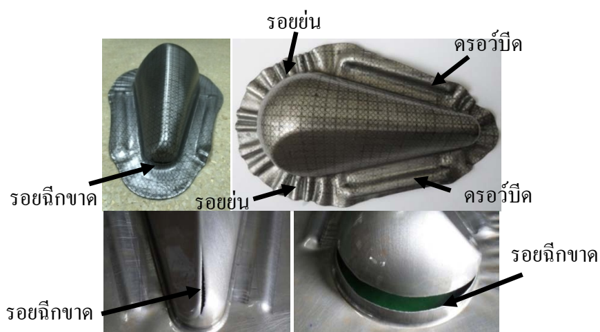
ภาพที่ 4.48 จุดบกพร่องชิ้นงานหลังการขึ้นรูปของครอว์บี
