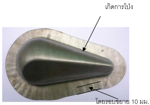
ภาพที่ 4.19 ชิ้นงานสำเร็จที่ไม่ใช้ดรอว์บีค
