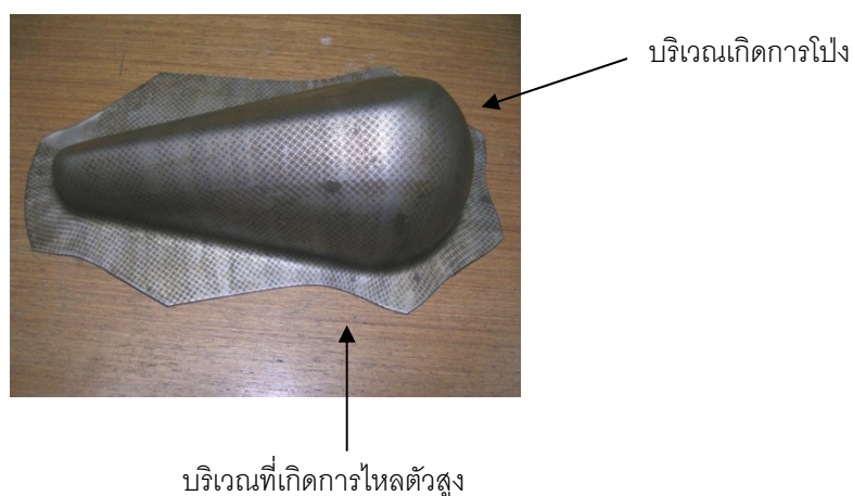
ภาพที่ 4.26 ชิ้นงานสำเร็จจากการขึ้นรูปของแผ่นตัดเปล่าสี่เหลี่ยมชนิดบากมุมเพื่อวิเคราะห์ผล
