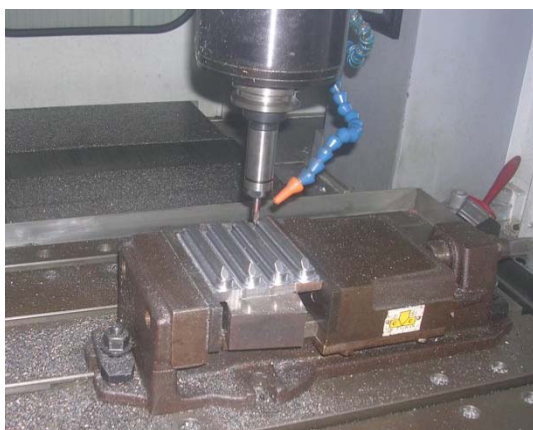
ภาพที่ 3.12 เครื่องกัดอัตโนมัติ เดินโปรแกรมตามที่ได้ตั้งไว้
