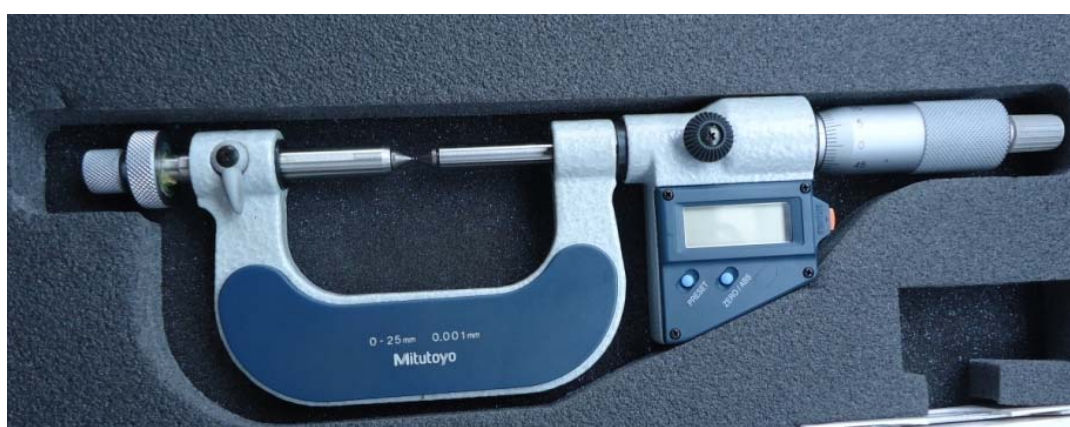
ภาพที่ 3.30 อุปกรณ์วัดความหนาผิวชิ้นงานด้วยไมโครมิเตอร์
