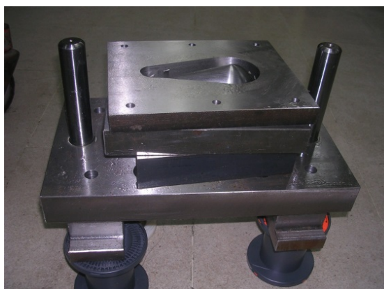
ภาพที่ 3.8 การใส่แผ่นเสริมรองขนาด
