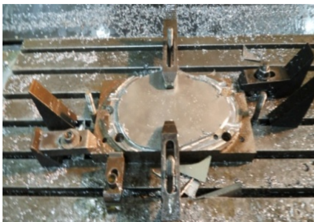
ภาพที่ 3.21 แผ่นชิ้นงานที่ผ่านการกัดด้วยเครื่องกัดอัตโนมัติ
