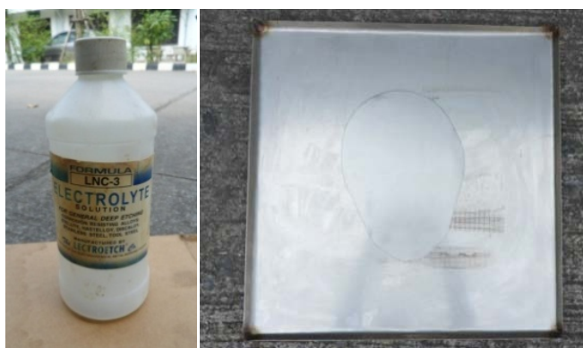
ภาพที่ 3.23 ทำความสะอาดแผ่นแบนลงกึ่งด้วยน้ำยาอิเล็กโทรไลต์และวางแผ่นแบนลงกึ่งบนถาด
