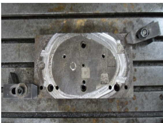
ภาพที่ 3.19 การติดตั้งอุปกรณ์จับยึด
