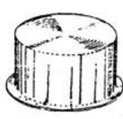
รอยตำหนิจากการลากขึ้นรูป
