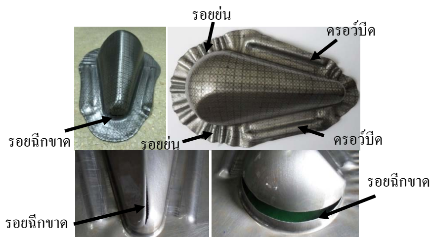
ภาพที่ 4.1 จุดบกพร่องชิ้นงานหลังการขึ้นรูปของครอว์ปิด
