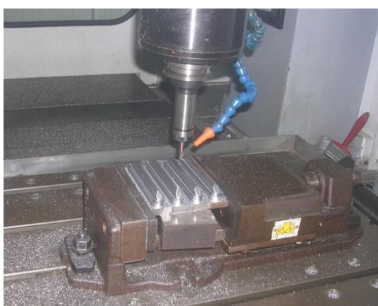
ภาพที่ 3.2 เครื่องกัดอัตโนมัติ เดินโปรแกรมตามที่ได้ตั้งไว้
