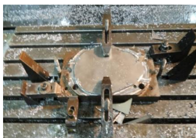
ภาพที่ 3.7 แผ่นชิ้นงานที่ผ่านการกัดด้วยเครื่องกัดอัตโนมัติ
