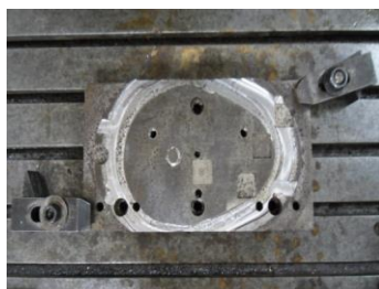
ภาพที่ 3.5 การติดตั้งอุปกรณ์จับยึด
