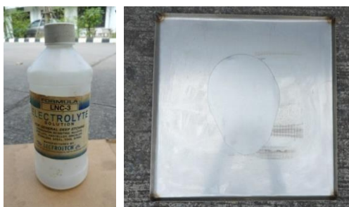
ภาพที่ 3.9 ทำความสะอาดแผ่นแบนลงด้วยน้ำยาอิเล็กโทรไลต์ และวางแผ่นแบนลงบนถาด
