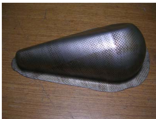
ภาพที่ 2.11 ชิ้นงานที่ขึ้นรูปและตีกริดเพื่อวิเคราะห์ความเครียดที่แผ่นชิ้นงาน
