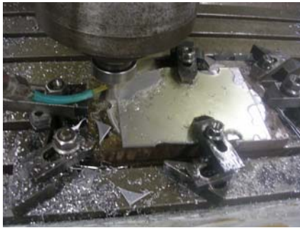
ภาพที่ 2.16 การกัดชิ้นงานและชิ้นงานสำเร็จ
