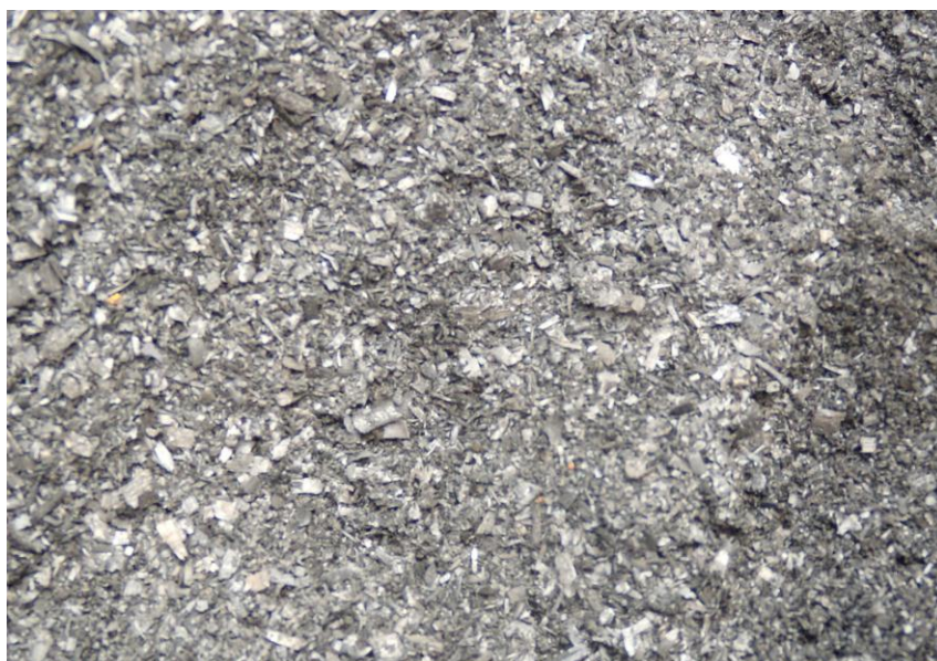
รูปที่ ก.10 จี้เลื่อยที่เผาออกมาไม่สมบูรณ์
