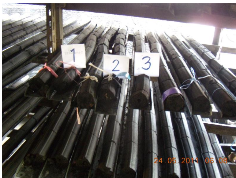
รูปที่ ค.4 ที่ตากถ่านหลังจากอัดแล้ว
