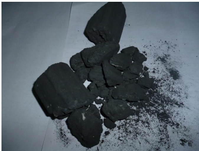
รูปที่ ก.19 ถ่านมีลักษณะขีดยกเกาะเป็นแท่งได้ไม่ดี เพราะและแตกหักมาก
