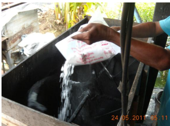
รูปที่ 2.3 การผสมถ่านกากมะพร้าวกลับถ่านขี้เลื่อยตามอัตราส่วนที่กำหนด
