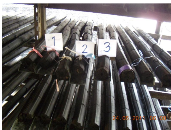
รูปที่ 2.5 การทำให้แห้งโดยการนำแท่งถ่านไปตากแดด
