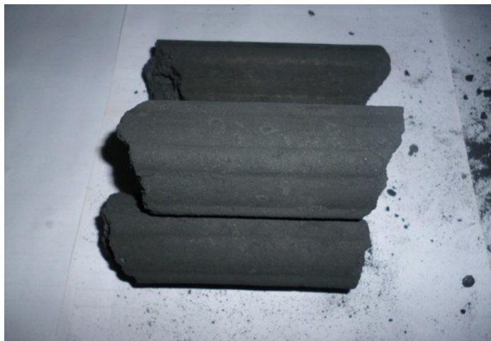
รูปที่ ก.15 ถ่านมีลักษณะขีดยัดเกาะเป็นแท่งได้ดี ผิวเรียบไม่มีรอยร้าว
