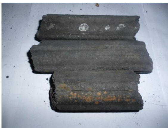
รูปที่ ก.18 ถ่านมีลักษณะขีดยกเกาะได้ดี แต่จะเปราะแตกหักได้ง่าย
