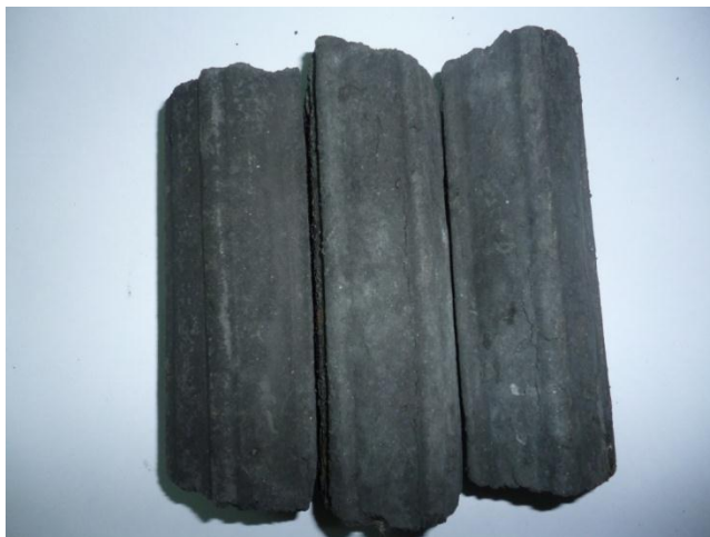
รูปที่ ก.13 ถ่านมีลักษณะยึดเกาะกันเป็นแท่งได้ดี แต่มีรอยร้าวเล็กน้อย
