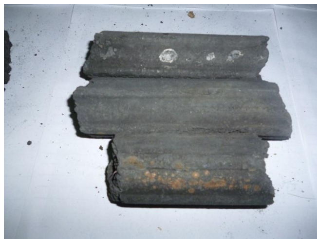
รูปที่ ก.16 ถ่านมีลักษณะขีดยัดเกาะเป็นแท่งได้ดี มีรอยร้าวเล็กน้อย
