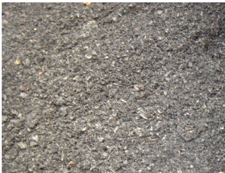
รูปที่ ก.11 กากมะพร้าวที่เผาออกมาไม่สมบูรณ์
