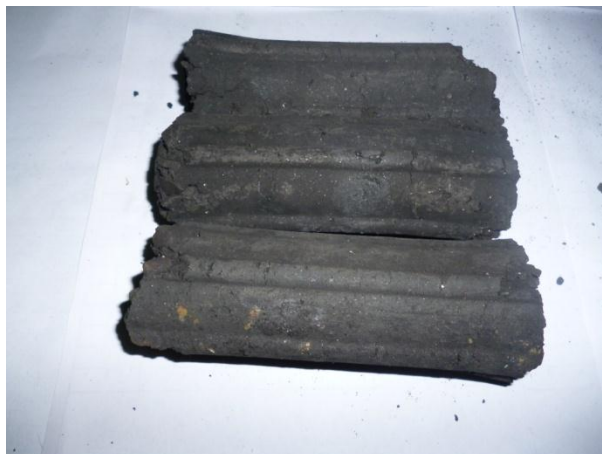
รูปที่ ก.17 ถ่านมีลักษณะขีดยกเกาะเป็นแท่งได้ดี แต่จะรอยร้าวเมื่อเริ่มแห้ง
