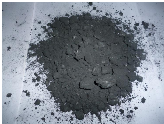
รูปที่ ก.12 ไม่สามารถอัดเป็นแท่งถ่านได้
