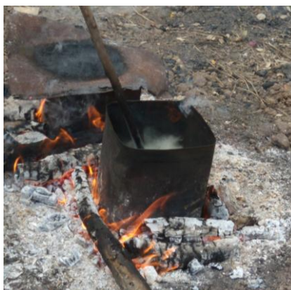
รูปที่ 3.12 วิธีการเผาถ่านที่วัสดุมีขนาดเล็ก
