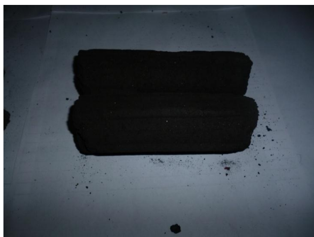
รูปที่ ก.14 ถ่านมีลักษณะยึดเกาะเป็นแท่งได้ดี ผิวเรียบ
