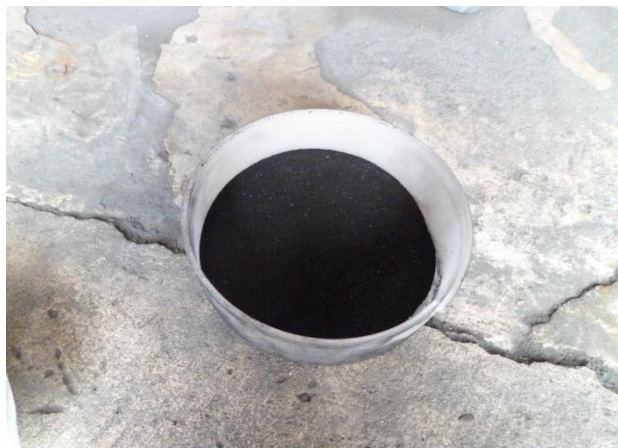
รูปที่ 3.4 กะลามะพร้าวที่ทำการบดละเอียด
