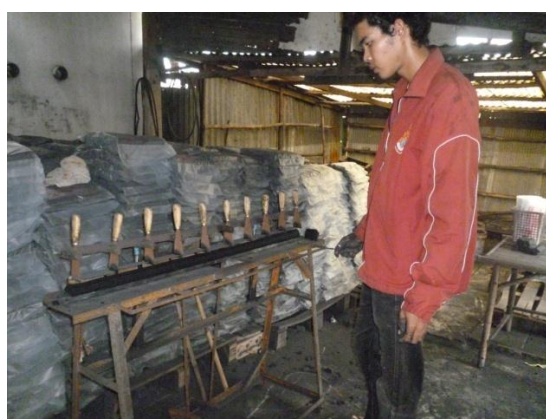
รูปที่ 3.41 การตัดความยาวของถ่านอัดแท่งเพื่อให้ได้ขนาด
