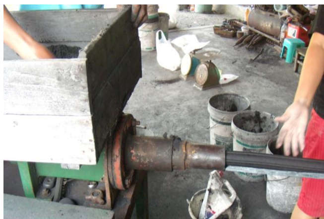
รูปที่ 2.4 การอัดเป็นแท่งตามรูปทรงที่กำหนด
