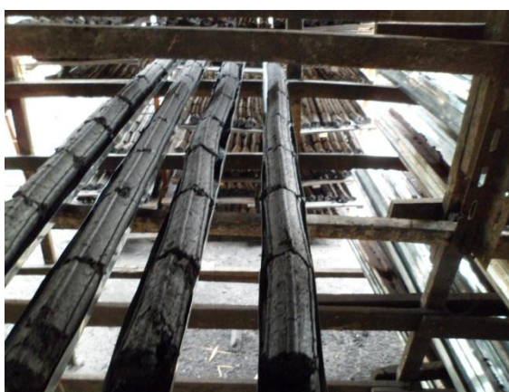
รูปที่ 3.39 ถ่านอัดแท่งยัดเกาะกันได้ไม่ดี เมื่อแห้งจะมีการแตกหัก
