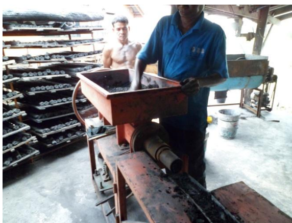
รูปที่ 3.32 การอัดแท่งถ่านไม่จับตัวเป็นแท่งถ่าน
