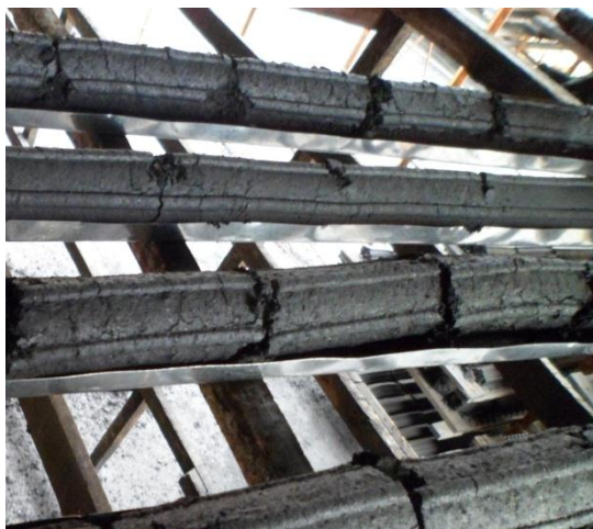
รูปที่ 3.38 ถ่านที่อัดแท่งที่ยัดเกาะกันได้ดี แต่มีรอยร้าวเมื่อแห้ง
