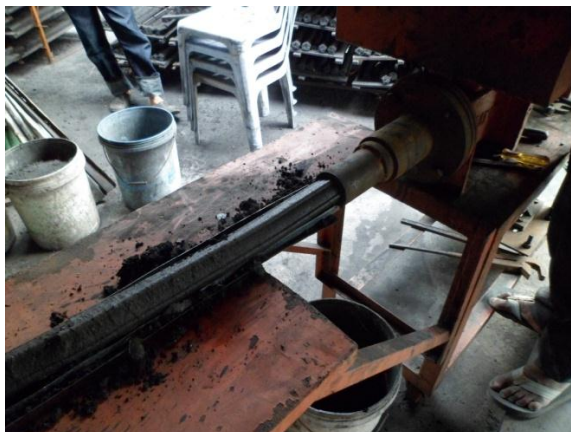
รูปที่ 3.34 ถ่านอัดแท่งได้คีมียรอยร้าวเล็กน้อย
