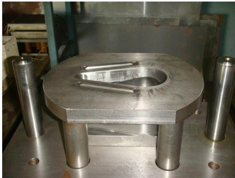
รูปที่ 3.17 การประกอบดรอว์บีคกับแผ่นกดชิ้นงาน
