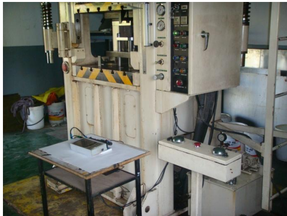
รูปที่ 3.31 การติดตั้งอุปกรณ์จัดเก็บสัญญาณต่อเข้ากับเครื่องเพรส
