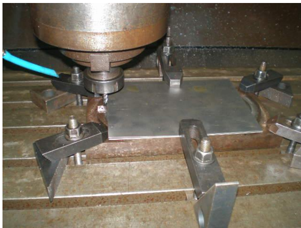
รูปที่ 3.6 การจับยึดชิ้นงานบนเครื่องกัด CNC
