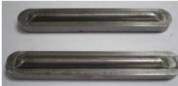
รูปที่ 3.26 ครอว์บีคที่เป็นโลหะเหล็กชนิด S45C
