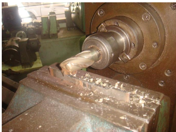
รูปที่ 3.17 ลักษณะการใช้เครื่องกัดชิ้นงานทดสอบแรงดึง
