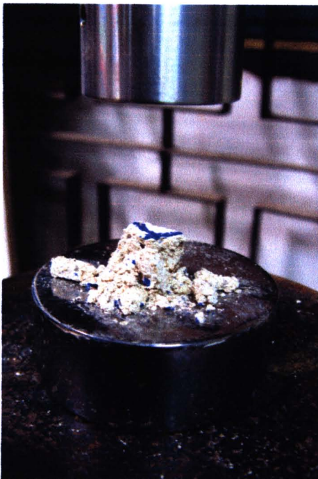
รูป จ-6 ลักษณะการวิบัติของมอร์ตาร์ขนาดเล็กก่อนการเสื่อมสภาพ
