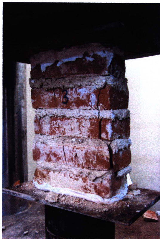
รูป จ-4 ลักษณะการวิบัติของปริซึมอิฐก่อนการเสื่อมสภาพ
