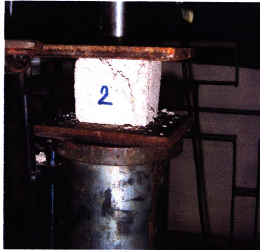
รูป จ-3 ลักษณะการวิบัติของมอร์ตาร์ก่อนการเสื่อมสภาพ
