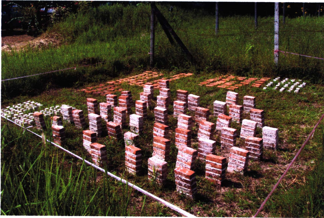
รูป จ-1 การวางตัวอย่างทดสอบเพื่อทดสอบการเสื่อมสภาพตามกระบวนการของธรรมชาติ
