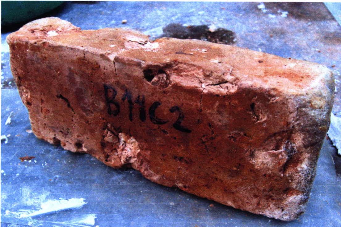
รูป จ-8 ลักษณะการเสื่อมสภาพแบบเร่งปฏิกิริยาของอิฐ สัปดาห์ที่ 11
