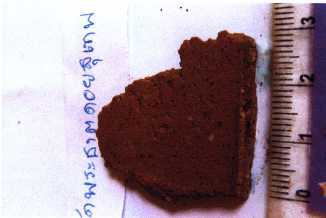
รูป จ-12 ลักษณะเนื้ออิฐภายในของเจดีย์วัดพระธาตุคอบสุเทพ
