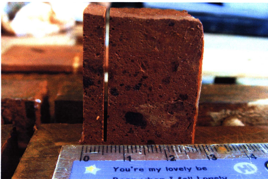
รูป ค-4 ลักษณะของรอยตัดจากเครื่องตัดหินตัวอย่างขนาดเล็ก
