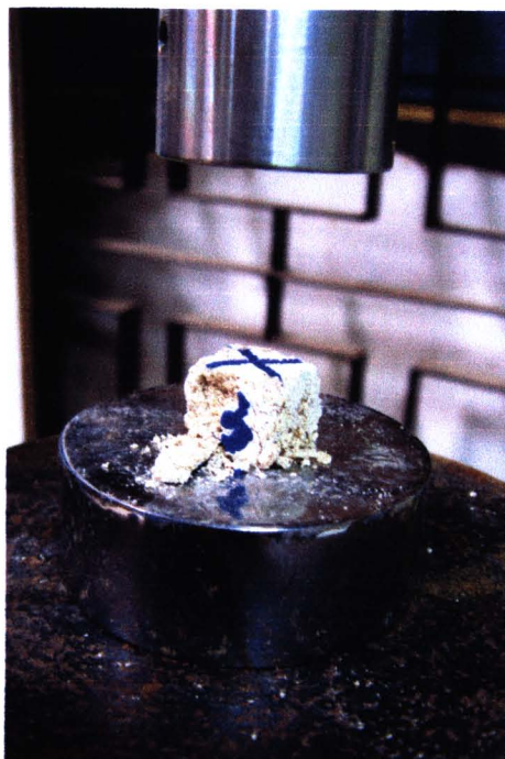
รูป จ-6 ลักษณะการวิบัติของมอร์ตาร์ขนาดเล็กก่อนการเสื่อมสภาพ
