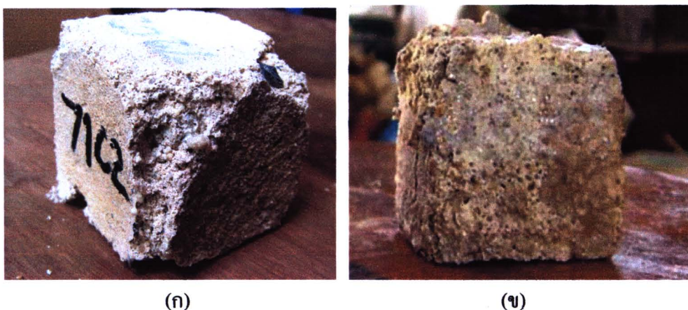
รูป 5.25 ลักษณะการถูกกัดกร่อนของมอร์ตาร์หลังการแช่กรดกำมะถันความเข้มข้นร้อยละ 3
