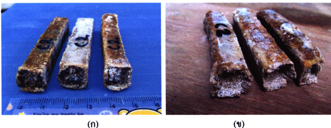
รูป 5.28 ลักษณะการเสื่อมสภาพของมอร์ดาร์เคลือบอีพ็อกซีที่ทดสอบการกัดกร่อนแบบเร่งปฏิกิริยา
