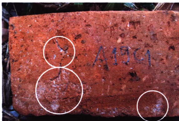
รูป 5.22 ผลึกสีขาวบนผิวอิฐหลังจากทดสอบการกักกร่อนตามกระบวนการของธรรมชาติ
