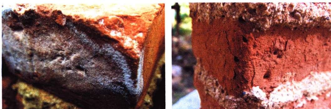
รูป 5.26 ลักษณะผลึกสีขาวและการเสื่อมสภาพที่ผิวอิฐของปริซึมอิฐก่อ
