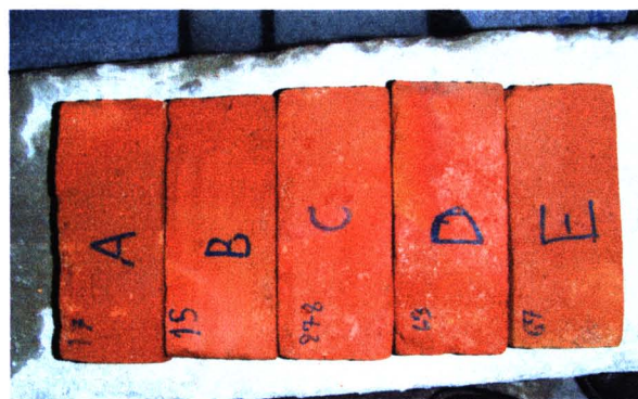
รูป 3.22 ลักษณะของอิฐที่ใช้ในการทดสอบหาค่าการดูดซึมน้ำของอิฐ
