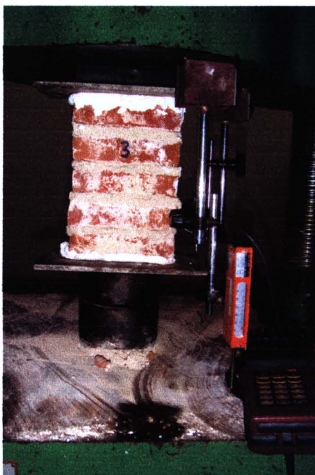
รูป 3.19 การทดสอบการรับกำลังอัดของปริซึมอิฐก่อ
