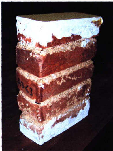
รูป 3.11 ลักษณะของปรีซึมอิฐก่อที่ใช้ในการทดสอบ
