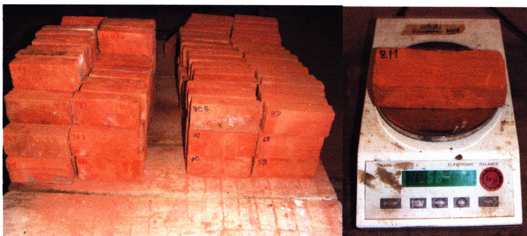
รูป 3.5 การเตรียมตัวอย่างอิฐที่ใช้ในการทดสอบ
