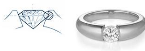
ภาพที่ 2.26 การฝังหนีบ (Tension Setting)
