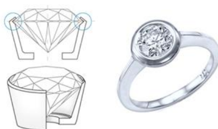
ภาพที่ 2.22 การฝังหุ้ม (Bezel Setting)
