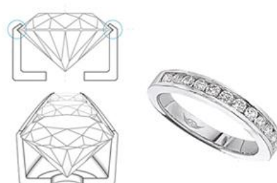
ภาพที่ 2.23 การฝังลึอกหรือฝังสอด (Channel Setting)
