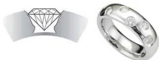
ภาพที่ 2.25 การฝังเหยียบหน้าหรือฝังจม (Flush Setting)
