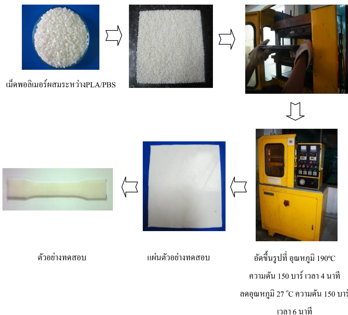
รูปที่ 3.3 ขั้นตอนการอัดขึ้นรูปพอลิเมอร์ผสมระหว่าง PLA/PBS ด้วยเครื่องอัดขึ้นรูป
