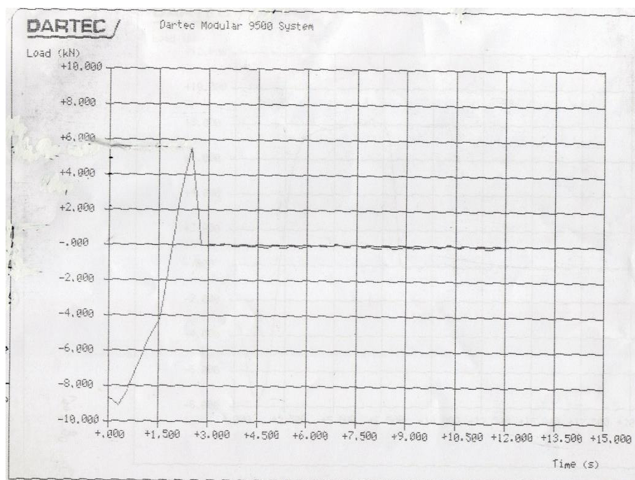
รูปที่ ข.7 ผลการทดสอบความต้านทานแรงดึงของอลูมิเนียมกับทองแดง ที่เชื่อมด้วยแรง 206 N/m 2
