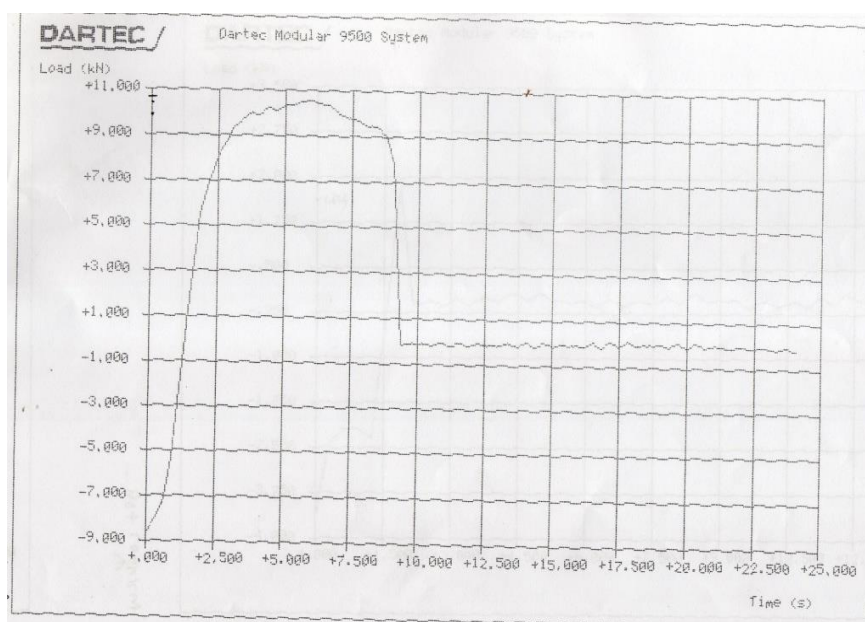
รูปที่ ข.4 ผลการทดสอบความต้านทานแรงดึงของอลูมิเนียมกับอลูมิเนียม ที่เชื่อมด้วยแรง 235 N/m 2
