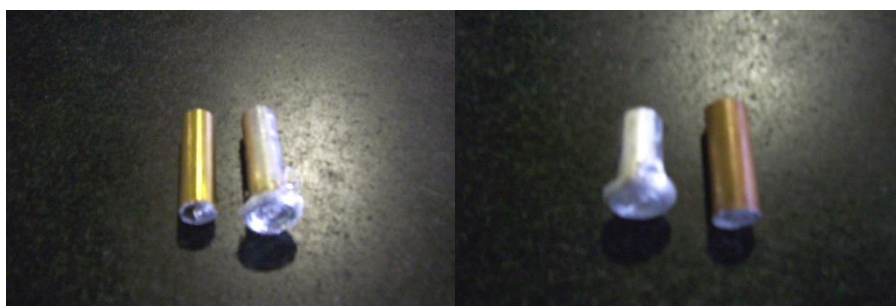
รูปที่ 3.15 แสดงชิ้นงานที่ผ่านการเชื่อมในความเร็วรอบ แรง และเวลากดแซ่ที่ไม่เหมาะสม
