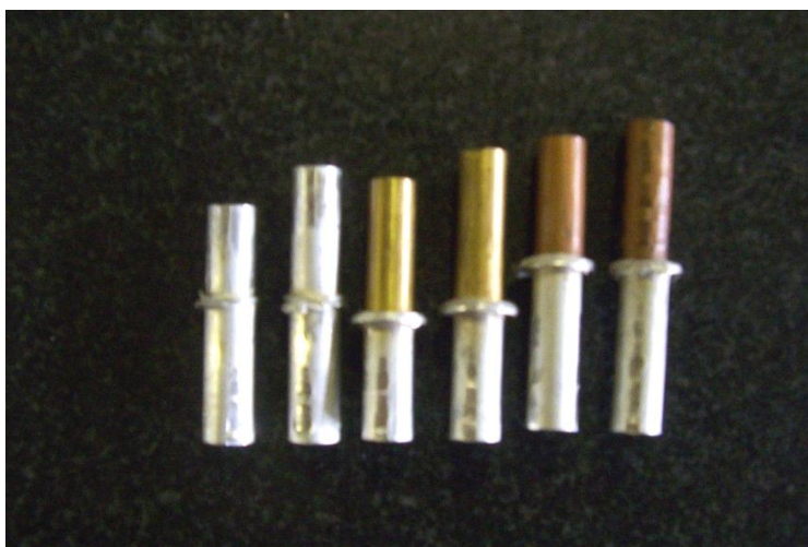
รูปที่ 3.14 ชิ้นงานที่ผ่านการเชื่อมด้วยความเร็วรอบ และแรงที่เหมาะสม
