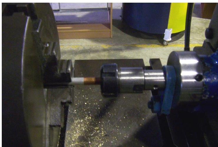
รูปที่ 3.12 แสดงการเคลื่อนที่ชิ้นงานเข้ามาชนกัน
