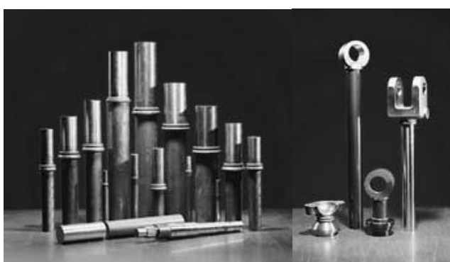
รูปที่ 2.17 ชิ้นงานที่ผ่านการเชื่อมแบบแรงเสียดทาน[1]
