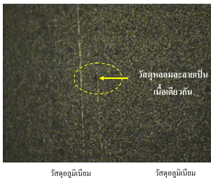
รูปที่ 4.27 แสดงการเชื่อมติดกันของอลูมิเนียมกับอลูมิเนียมที่แรงดัน 206\text{N/m}^2 (ขยาย 100X)
