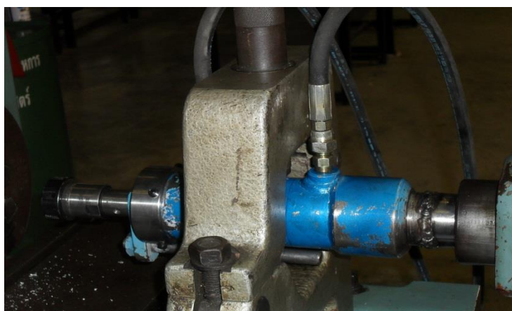
รูปที่ 3.3 กระบอกไฮดรอลิกส์
