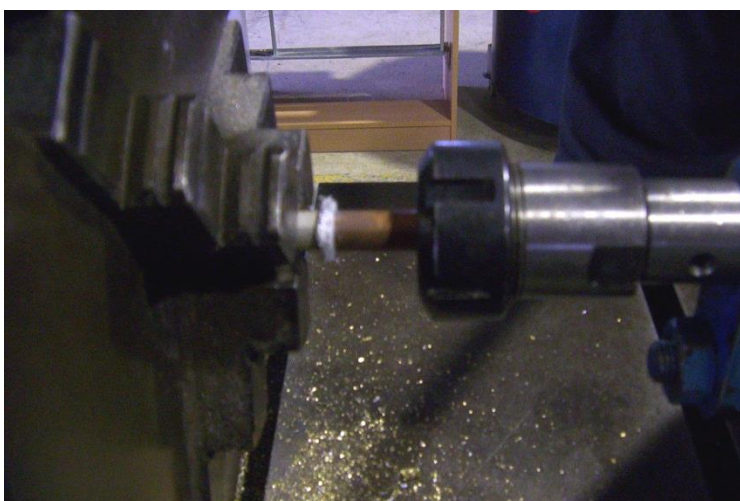
รูปที่ 3.13 แสดงการเชื่อมติดกันของ อลูมิเนียมกับทองแดง
