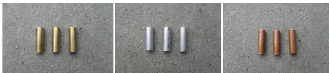
รูปที่ 3.6 ชิ้นทดสอบ ทองเหลือง อลูมิเนียม และทองแดง
