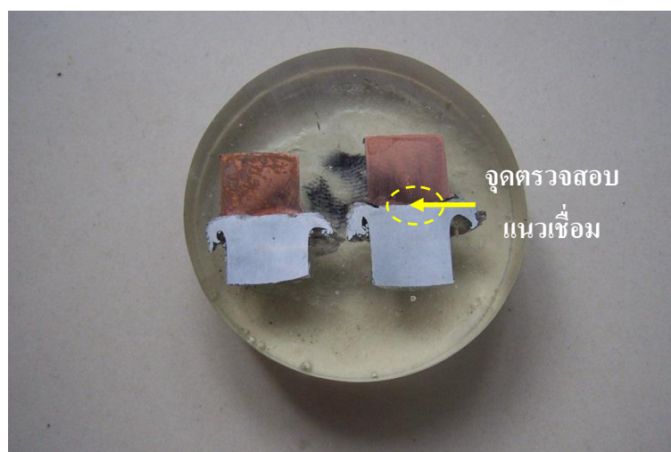
รูปที่ 4.40 ชิ้นงานที่นำไปตรวจสอบโครงสร้างในการเชื่อมติดกันของแนวเชื่อมที่แรงดัน 176\text{N/m}^2
