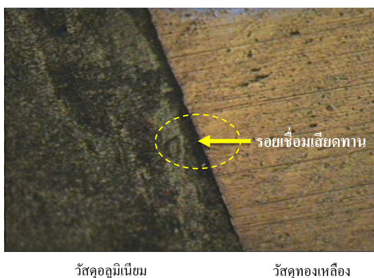
รูปที่ 4.35 แสดงการเชื่อมติดกันของอลูมิเนียมกับทองเหลืองที่แรงดัน 206 \text{ N/m}^2 (ขยาย 100X)
