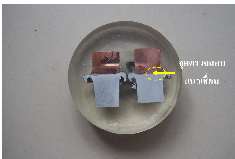
รูปที่ 4.44 ชิ้นงานที่นำไปตรวจสอบโครงสร้างในการเชื่อมติดกันของแนวเชื่อมที่แรงดัน 235 \text{ N/m}^2
