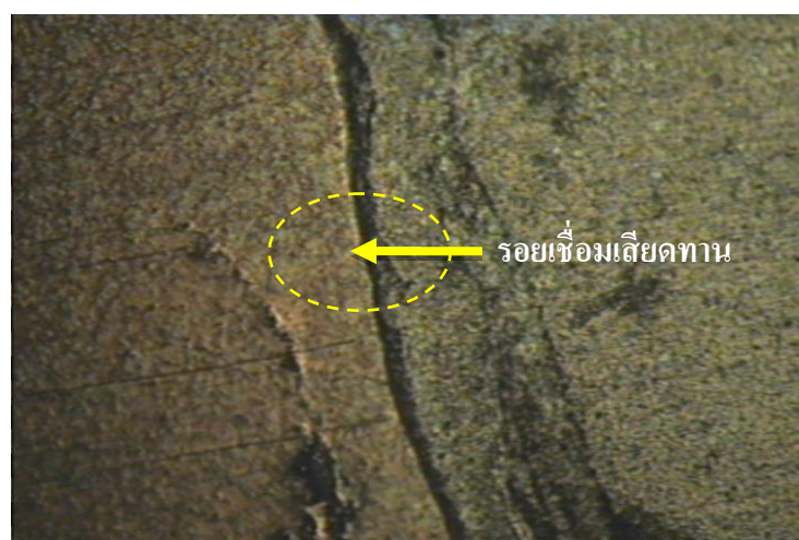
รูปที่ 4.30 ชิ้นงานที่นำไปตรวจสอบโครงสร้างในการเชื่อมติดกันของแนวเชื่อมที่แรงดัน 147\text{N/m}^2
