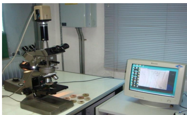
รูปที่ 3.21 ตรวจสอบรอยเชื่อมด้วยการผ่าแล้วนำไปส่องกล้อง Microscope
