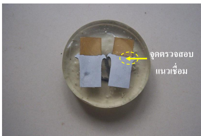
รูปที่ 4.32 ชิ้นงานที่นำไปตรวจสอบโครงสร้างในการเชื่อมติดกันของแนวเชื่อมที่แรงดัน 176\text{N/m}^2
