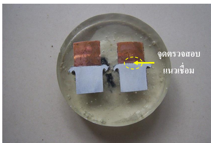
รูปที่ 4.42 ชิ้นงานที่นำไปตรวจสอบโครงสร้างในการเชื่อมติดกันของแนวเชื่อมที่แรงดัน 206\text{N/m}^2
