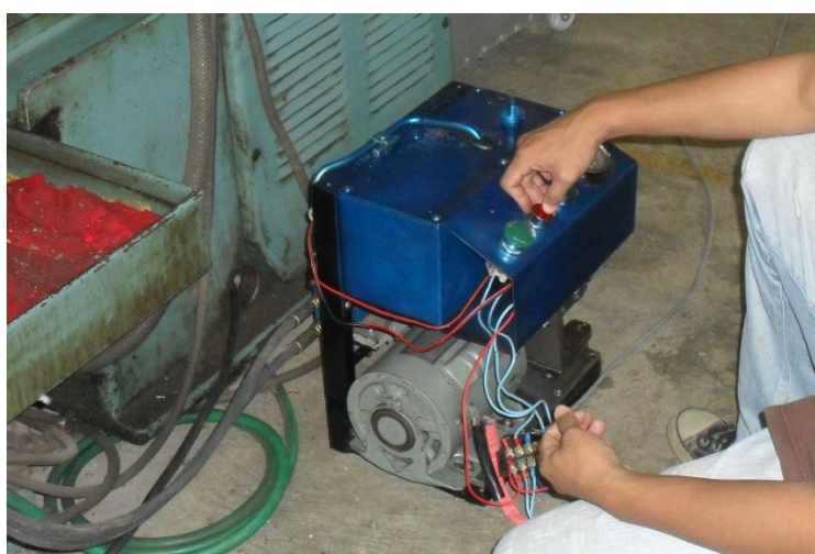
รูปที่ 3.11 แสดงการปรับตั้งขนาดของแรงดัน
