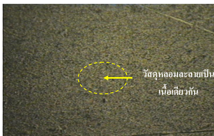
รูปที่ 4.24 ชิ้นงานที่นำไปตรวจสอบโครงสร้างในการเชื่อมติดกันของแนวเชื่อมที่แรงดัน 176\text{N/m}^2
