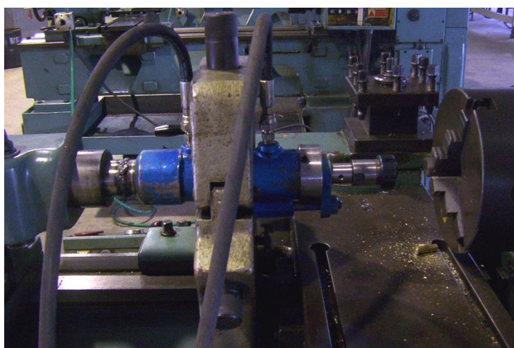
รูปที่ 3.7 การติดตั้งชุดให้แรงดันให้ได้ระยะที่เหมาะสม
