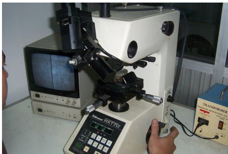
รูปที่ 3.23 แสดงการตรวจสอบความแข็งแรงของผิวรอยเชื่อม
