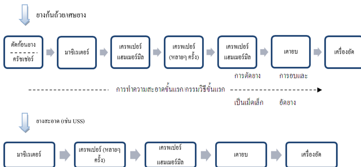
รูปที่ 2.12 แสดงแผนผังลำดับการเรียงเครื่องจักรต่างๆ เพื่อผลิตยางแท่ง ที่มา วราภรณ์ ขจรไชยกูล, ยางธรรมชาติ: การผลิตและการใช้งาน. 2549
