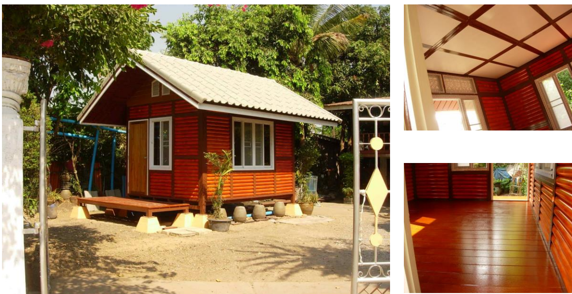
ภาพที่ 7.4 แสดงลักษณะบ้านพักอาศัยสำเร็จรูปจากท่อนไม้เทียมซีเมนต์เยื่อกระดาษเสริมเหล็กเส้น
